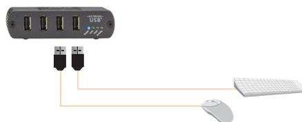
FIGURE QS-8. CONNECT USB DEVICE(S) TO THE REMOTE EXTENDER
