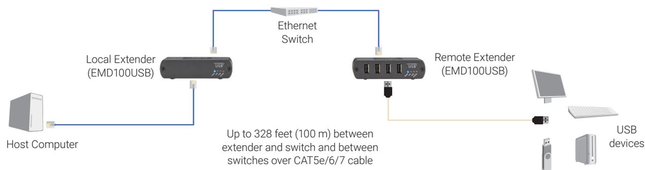
FIGURE 3-1. EMD100USB INSTALLED ON A LOCAL AREA NETWORK
