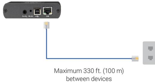
FIGURE QS-1. CONNECT THE LOCAL EXTENDER TO A NETWORK SWITCH
