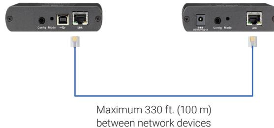
FIGURE QS-5. CONNECT THE LOCAL EXTENDER TO THE REMOTE EXTENDER
