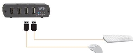
FIGURE QS-4. CONNECT A USB DEVICE TO THE REMOTE EXTENDER
