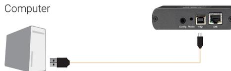
FIGURE QS-2. CONNECT THE LOCAL EXTENDER TO A COMPUTER
