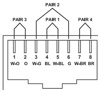
FIGURE 6-3. T568B CONNECTOR PINOUT
