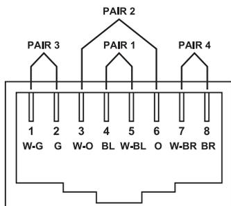
FIGURE 6-2. T568A CONNECTOR PINOUT
