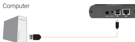
FIGURE QS-6. CONNECT THE LOCAL EXTENDER TO A COMPUTER
